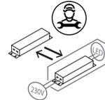
2. Dispositivo de controlo substituível apenas por um técnico qualificado. / Control device replaceable only by a qualified technician. / El equipo de control sólo puede ser reemplazado por un técnico cualificado.
